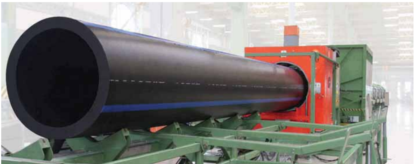
PE 100 Ø 1200 mm PN 16 boru et kalınlığı, s: 109.1 mm'dir
