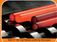
900 C' de normalize edilmiş Borusan doğal gaz borusu.
